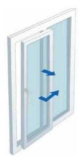
Apertura osciloparalela mediante carril exterior.
